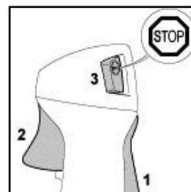
Bouton d'arrêt: Avec les positions pour **marche normale** et **stop**. Pour couper le contact, il faut enfoncer le bouton d'arrêt.
